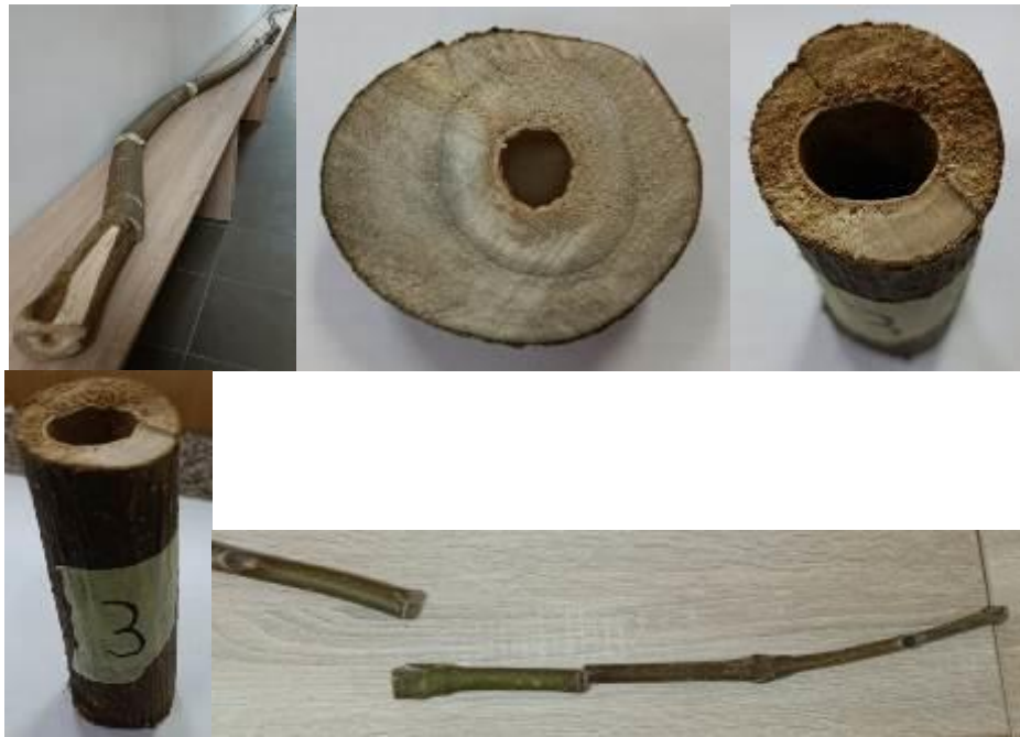
Рис. 3. Загальний вигляд об'єкта дослідження та характерні пропорції відношення внутрішньої порожнини та зовнішнього діаметра залежно від висоти перерізу.
