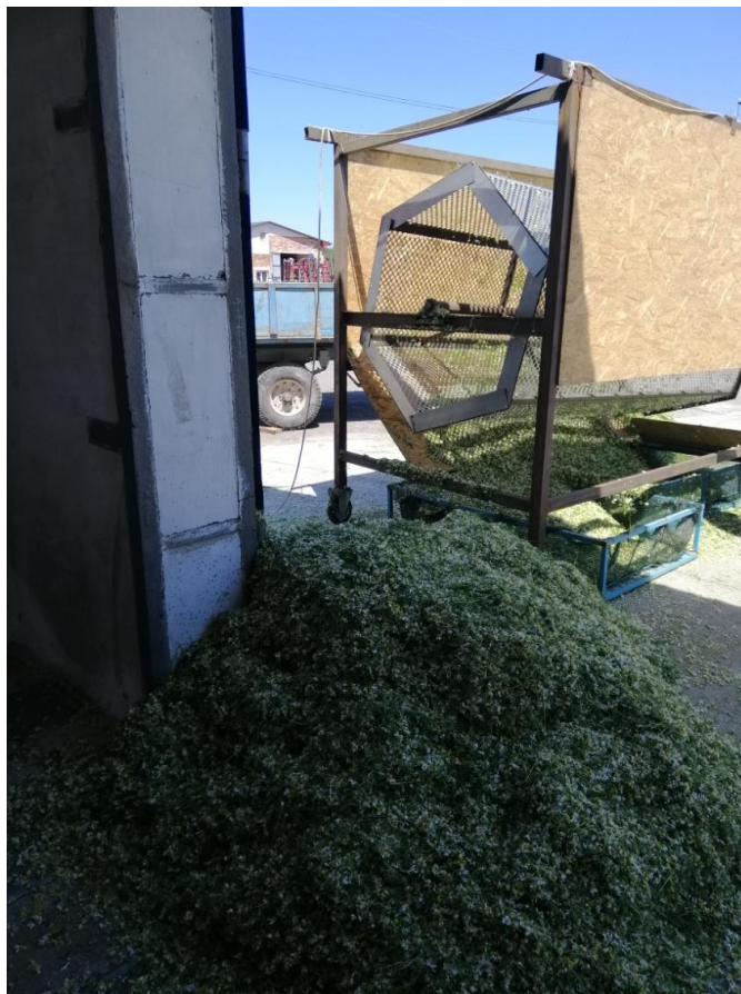
Рис. Л.2.1. Первинна очистка та калібрування суцвіть ромашки очисною машиною «барабан» власного виробництва
