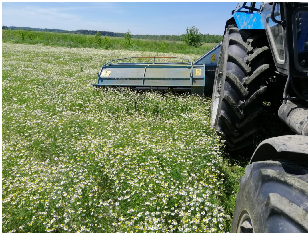
Рис. Л.1.1. Механізоване збирання суцвіть ромашки за допомогою комбайна марки NB2008V в умовах господарства ТОВ «КСАНТ – 2» Житомирської області Малинського району
