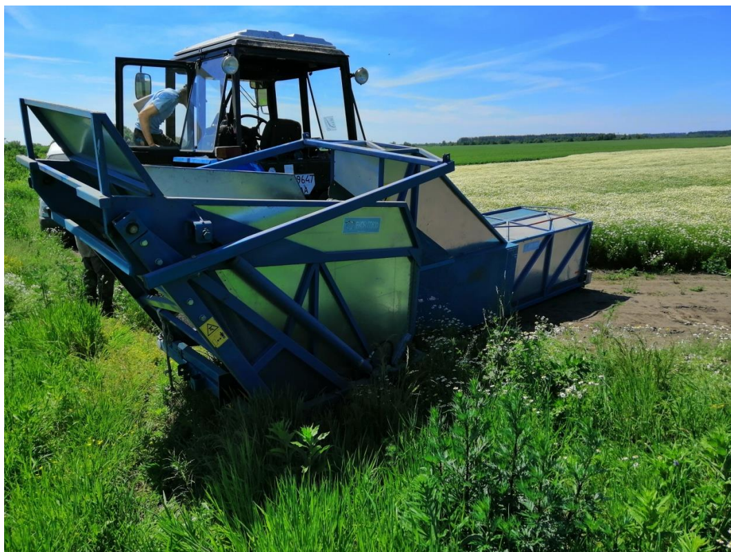
Рис. Л.1.2. Комбайн для збирання суцвіть ромашки лікарської – NB2008V
