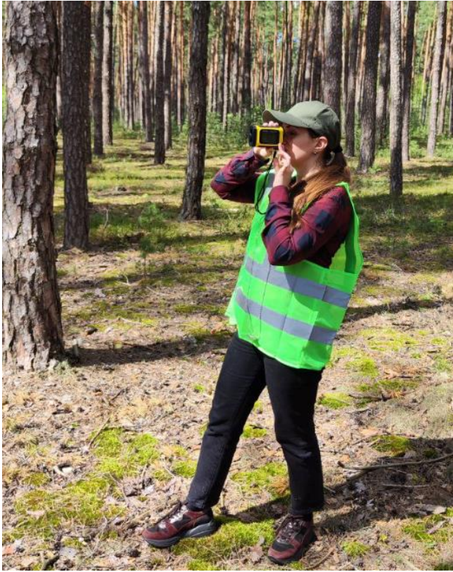
Рис. 2.5. Визначення проглядуваності насаджень на РПП, А – вигляд приладу збоку, Б – фокусування силуету людини через об'єктив
