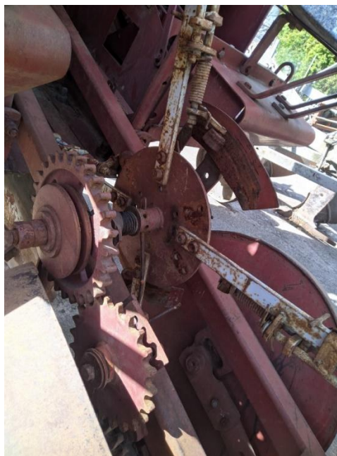
Рис. 2. Верхній та нижній розкривачи - заводська конструкція лісосадильної машини МЛУ-1
