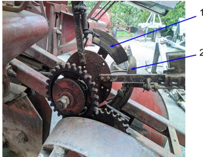
Рис. 3. Верхній розкривач і нижній розкривач, зміненої конструкції лісосадильної машини МЛУ-1
